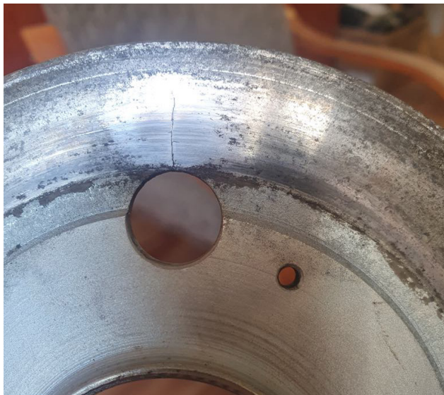
Fot. 5 Pęknięte, ale jeszcze działa
