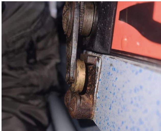
Fot. 5 Nieprawidłowe funkcjonowanie zamka kabiny w szybowcu „Puchacz” (fot. D. Deptuła)
