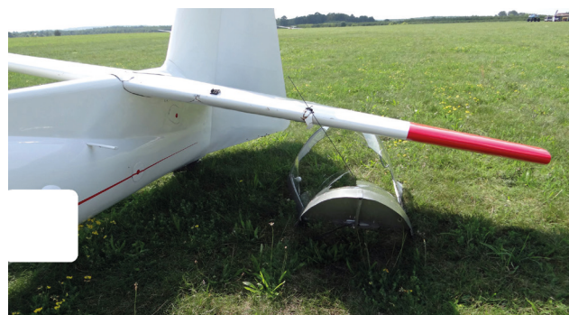
Fot. 1 Skutki uderzenia owiewki w usterzenie poziome (źródło CBZ)
