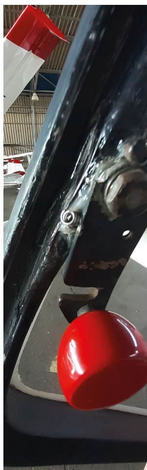
Fot. 6 Jantar 2B uszkodzony zamek (mat. autora)
