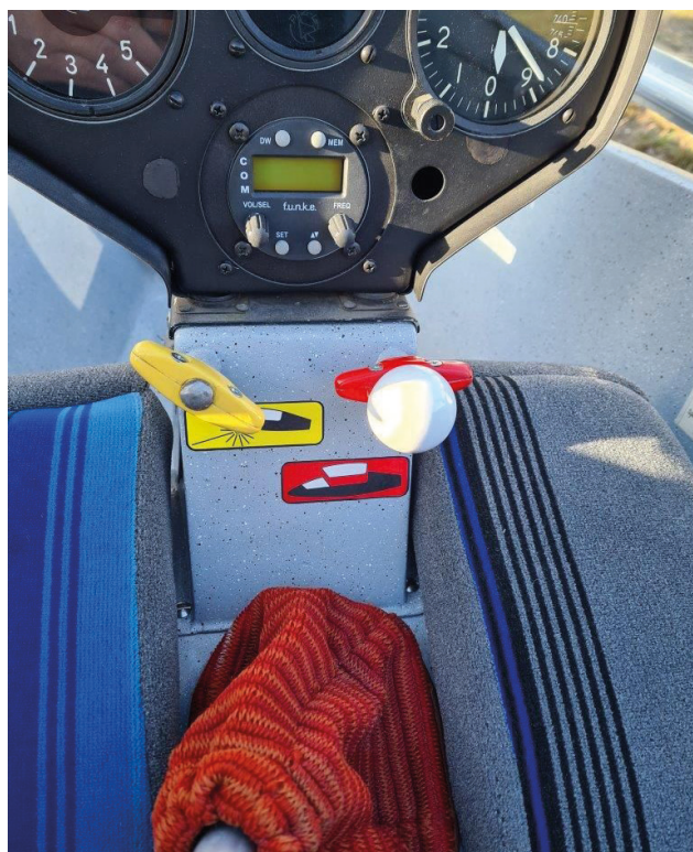
Fot. 4 Podwójny uchwyt otwierania i zrzutu awaryjnego kabiny w szybowcu Foka 5 (fot. D. Deptuła)
