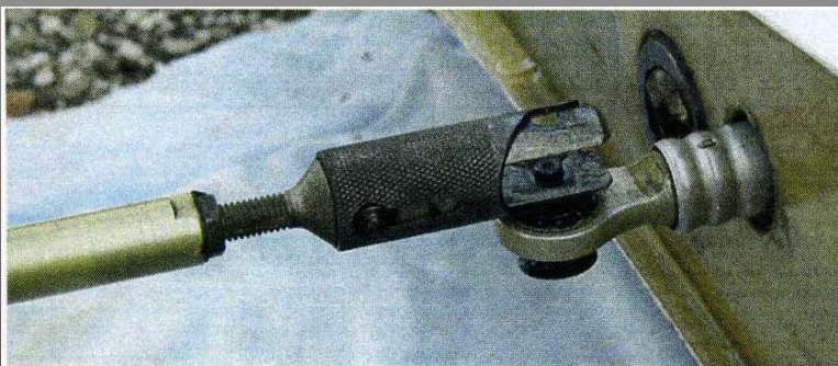
20a i 20b – Możliwość wadliwego połączenia popychaczy – przypuszczalna przyczyna wypadku.
