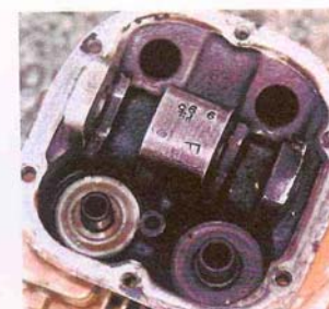
2a, 2b. Komora zaworowa z silnika ze zdarzenia nr 69/04, który przepracował ok. 490 h – widoczne zaczernienia od spalonego na skutek przegrzania oleju; komora jest znacznie ciemniejsza niż na zdjęciach 1a i 1b.
