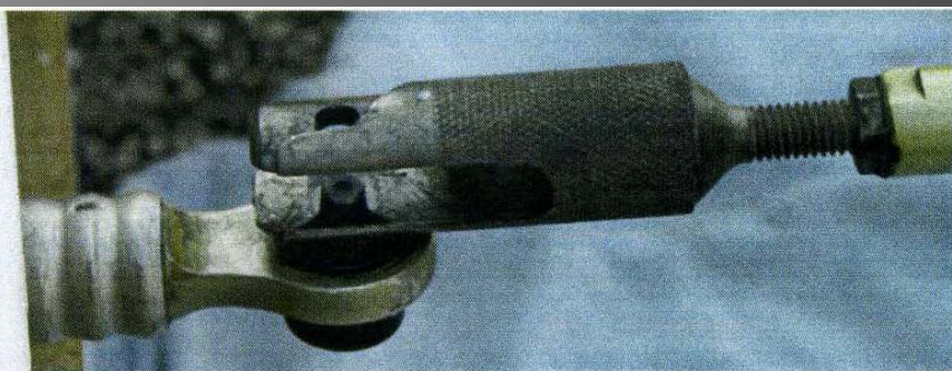
20a i 20b – Możliwość wadliwego połączenia popychaczy – przypuszczalna przyczyna wypadku.
