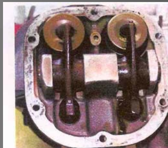
1a, 1b. Komora zaworowa z silnika nie uczestniczącego w zdarzeniu (dla porównania), który przepracował ok. 460 h w prawidłowych warunkach – brak widocznych śladów spalonego oleju na głowicy.
