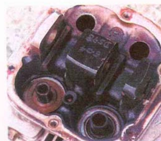
3a, 3b. Komora zaworowa z silnika ze zdarzenia nr 192/06, który przepracował ok. 680 h – widoczne zaczernienia od spalonego na skutek przegrzania oleju.
