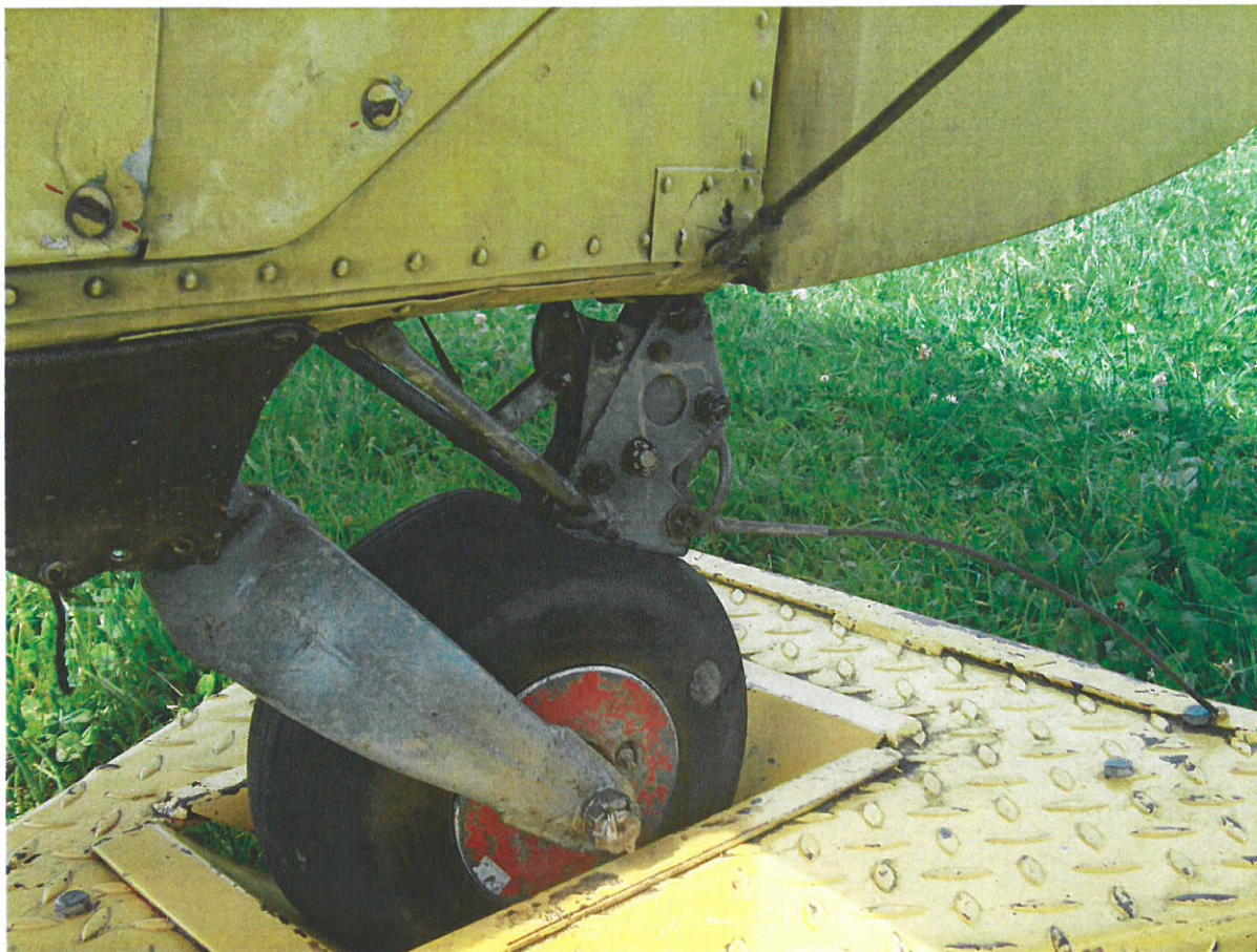
Fot.1 – Ogólny widok podwozia ogonowego i zaczepu holowniczego po wypadku na samolocie SP-AAB.
