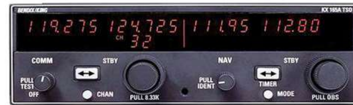
Rysunek 1 Odbiornik NAV/COM KX-165A
