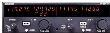
Rysunek 2 Odbiornik NAV/COM KX-165A
